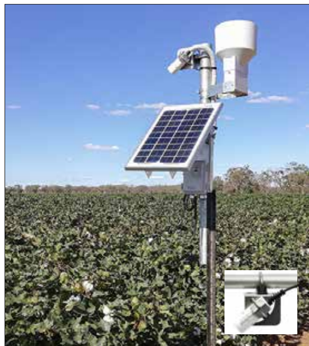
CWSI e Pioggia registrati in coltura di cotone e trasmessi dal sistema LTE Cat M1/Cat NB1/EGPRS - Narromine NSW
