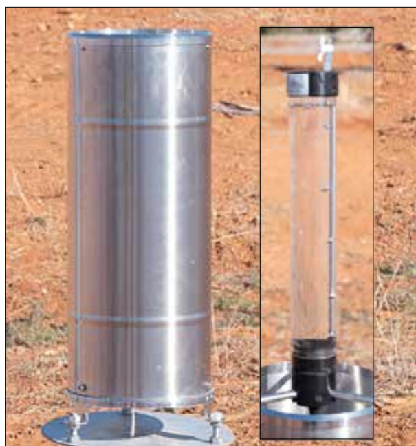
Figura della calibrazione della vaschetta basculante del pluviometro TBRG Field Kit in uso con un SRG0 di ICT International.
