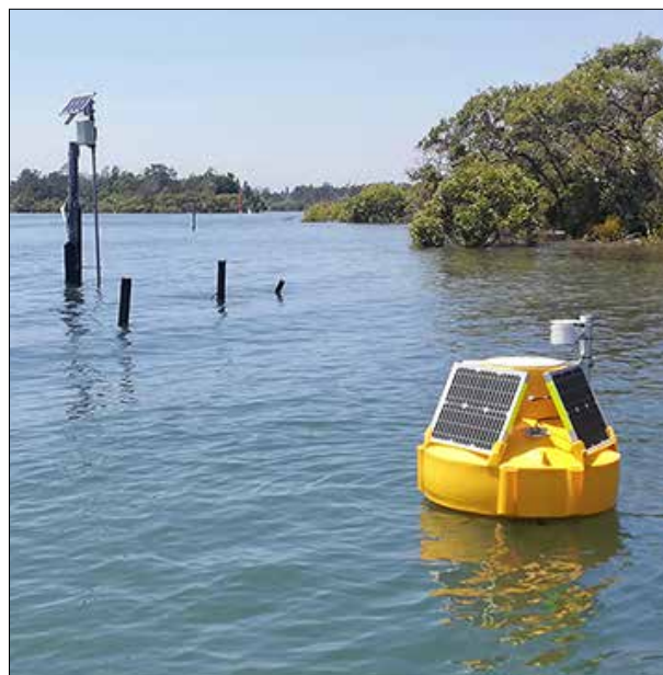
Monitoraggio della qualità dell'acqua con boa basata su Cat-M1 e localizzata nella costa centro-settentrionale in NSW, Australia
