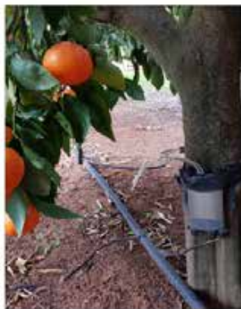
Misuratore del Flusso di Linfa Sap Flow Meter su alberi di agrumi pg. 22
